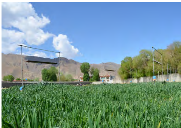
图1 麦田远红外开放式增温(FATI)系统。
