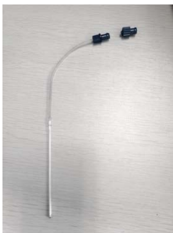
图1 根际土壤溶液采样器示意图。
